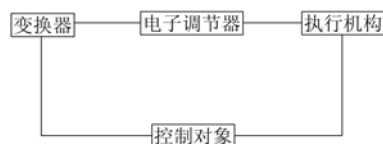
图 III-1-12 电子调节系统的控温原理
