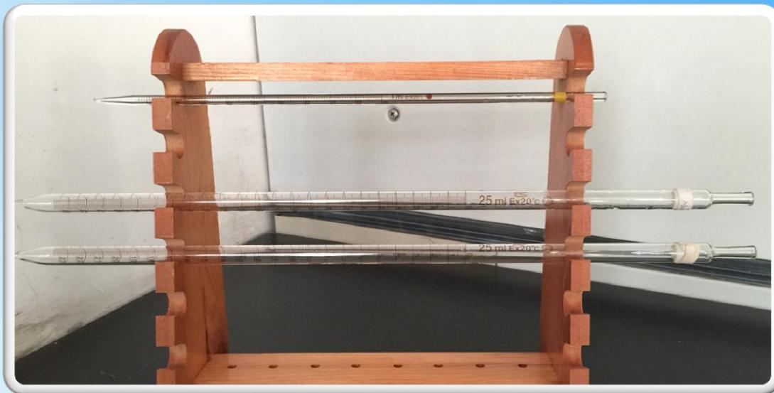
25 mL移液管2支；1 mL移液管1支
